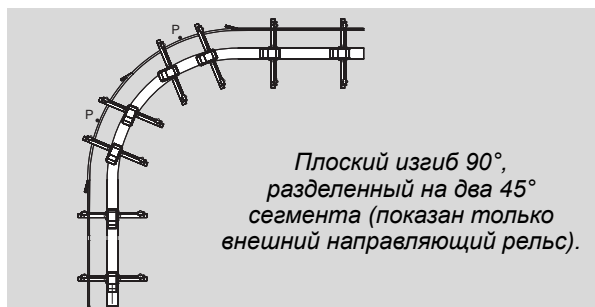
Секции направляющих рельсов должны заходить одна за другую.
