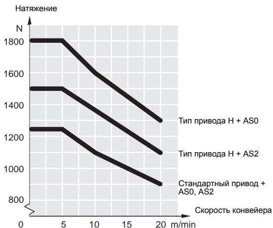
Диаграмма 2. Зависимость максимального натяжения цепи от скорости конвейера
