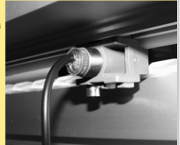
Крепежная скоба горизонтального датчика приближения \varnothing 18 \text{ мм} ХКРВ 18 Н Полиформальдегид. Включает винт, гайку к Т-пазу и шайбу
